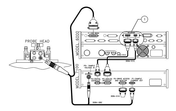
1) THESE CABLES MAY GO TO THE OPTION CONTROLLER DEPENDING ON SYSTEM CONFIGURATION.
